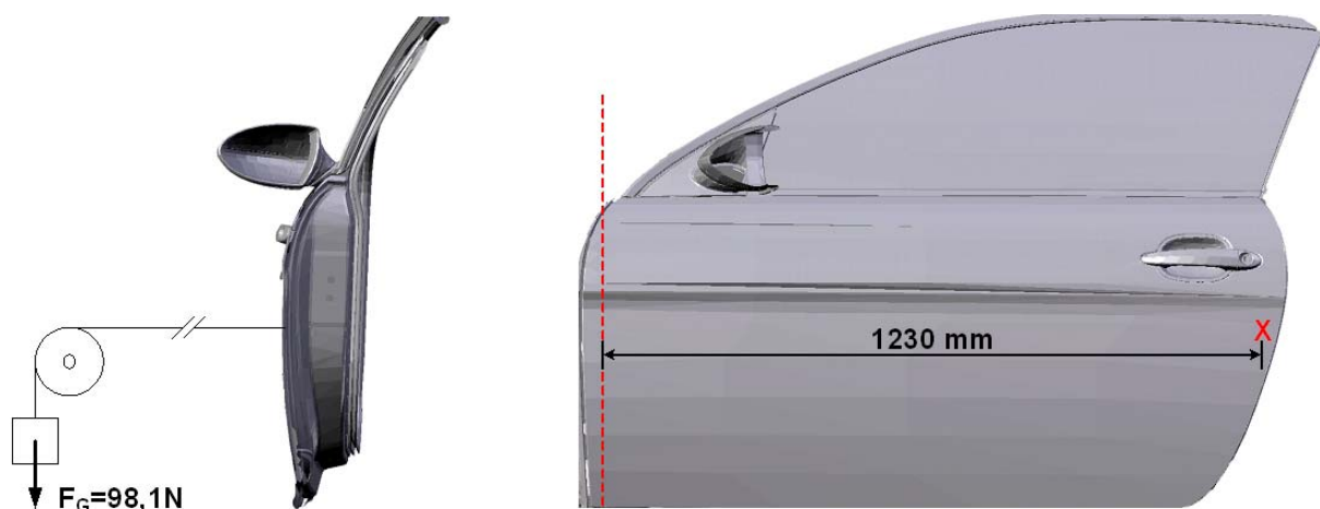
Bild 2: Versuchsstand zur Validierung der Beschleunigungsmessung
